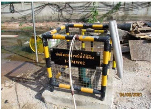
บ่อสังเกตการณ์น้ำใต้ดินท้ายน้ำ ของโรงงานผลิตสารโอเลฟินส์ โรงที่ 1/2
